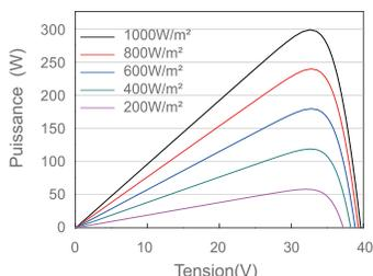
Courbe courant-tension JAM60S01-300/PR
