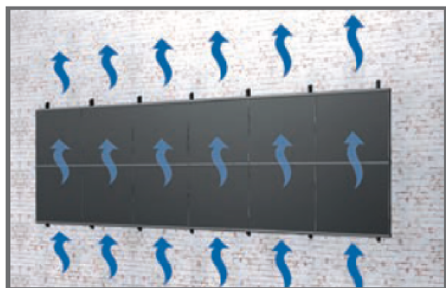
Ventilazione posteriore del modulo per mantenere prestazione e resa stabili attraverso il raffreddamento
