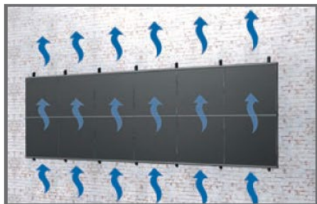
Kühlende Modul-Hinterlüftung für stabile Leistung und Ertrag
